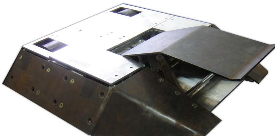
Figura 1.4 – Laterais em aço temperado depois de sua montagem.
