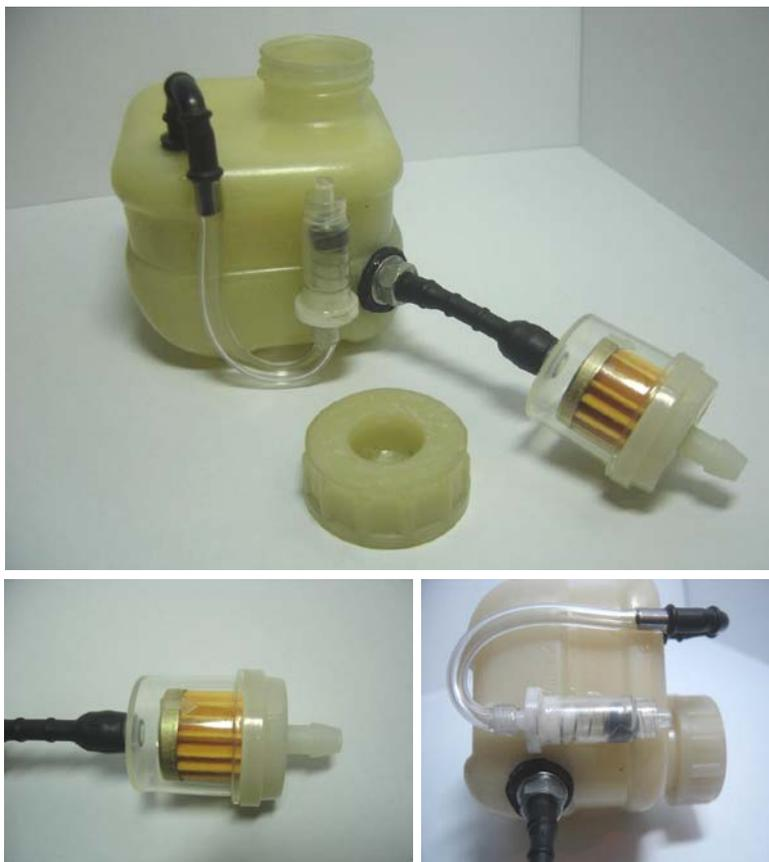
Figura 1.29 – Tanque e em detalhe válvula de ar e filtro de gasolina.
