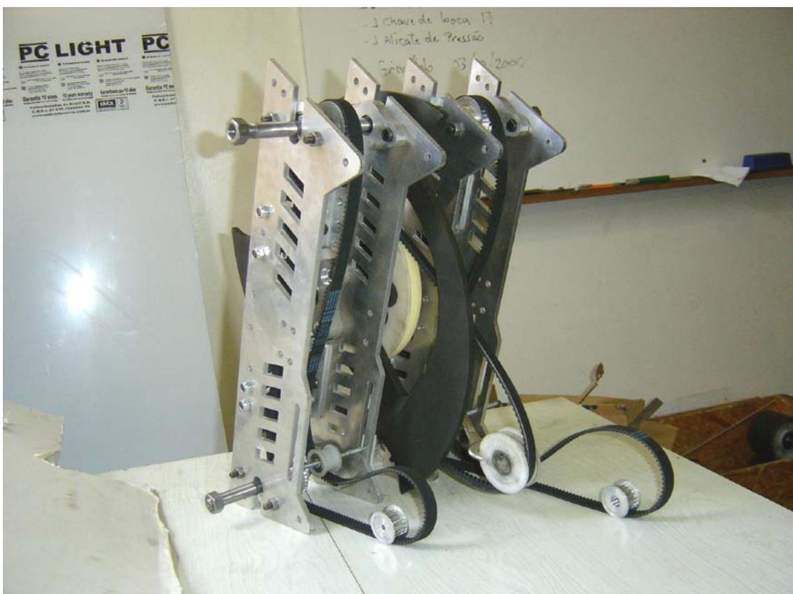
Figura 5.2 - Torre principal em alumínio do Robô Docinho, com todas as suas polias e correias corretamente alocadas, juntamente com o sistema da arma.
