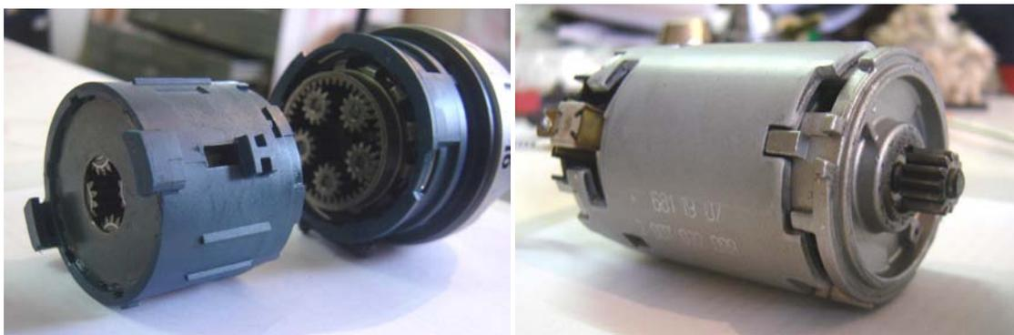
Figura 4.2 - Fotos detalhadas do Motor e suas reduções planetárias.
