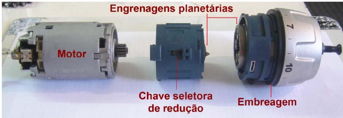
Figura 4.1 – Detalhe motor parafusadeira
