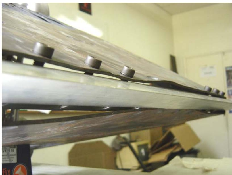
Figura 1.33 – Detalhes dos empenamentos provocados pela têmpera errônea da chapa de aço, o que inviabilizou sua montagem.
