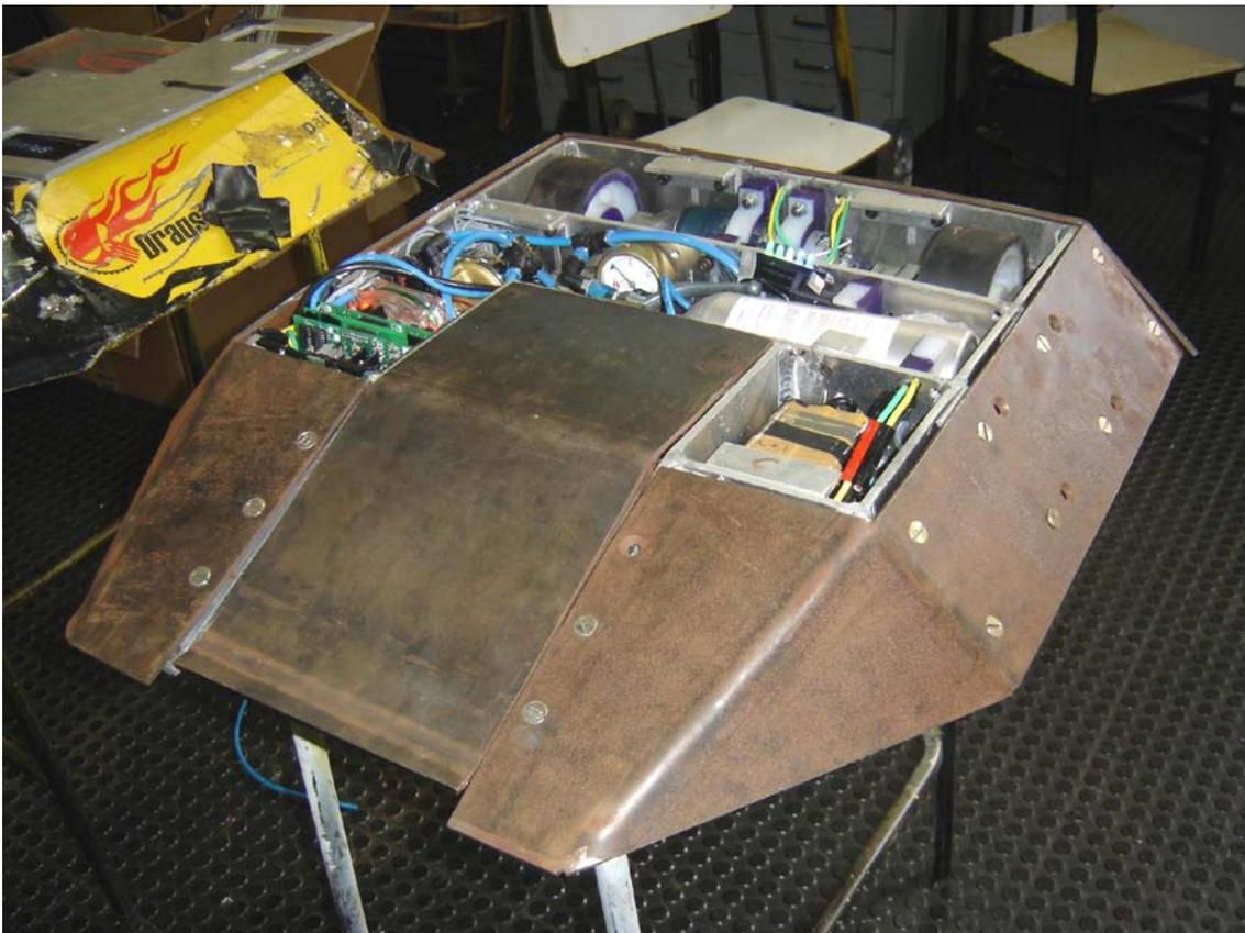
Figura 5.5 - Kako Completo, instalação dos últimos sistemas e detalhes. Apenas aguardando testes e pintura.
