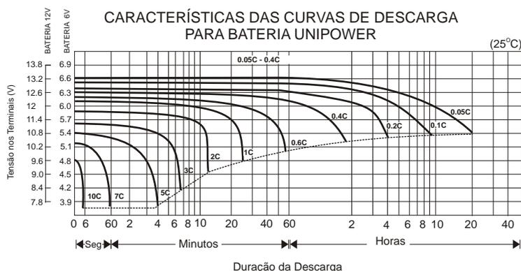
As baterias chumbo-ácidas seladas reguladas por válvula em geral perdem a sua capacidade nominal e vida útil quando descarregadas abaixo do valor recomendado da tensão de corte. Se a bateria for descarregada até 0V/elemento e permanecer por um período longo de tempo sem carga, a bateria sofrerá “sulfatação” e terá um aumento na sua resistência interna. Em alguns casos, a bateria poderá não mais aceitar carga.
